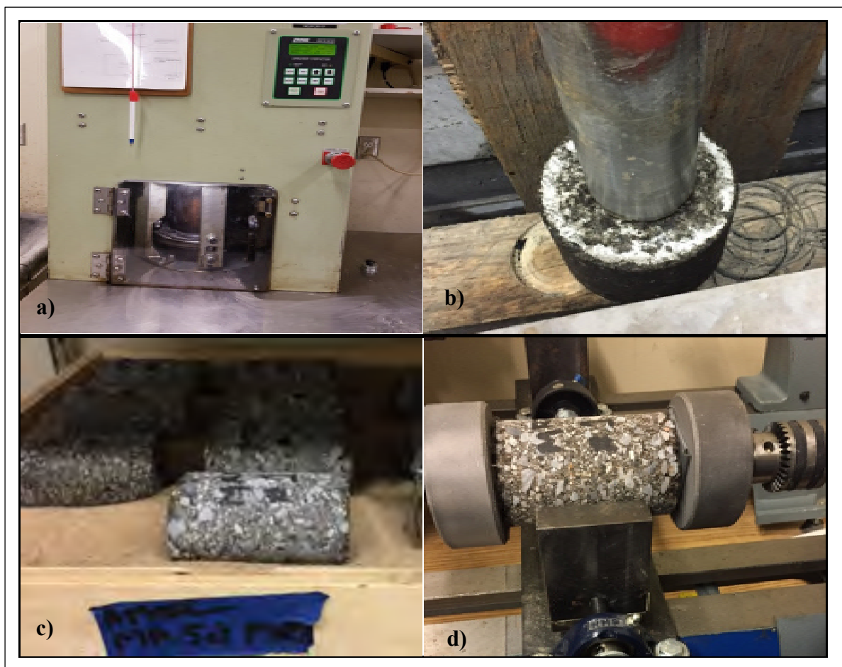
Figure 3.4 Préparation des éprouvettes pour l'essai de module complexe (a) Compactage à la PCG (b) Carottage des éprouvettes (c) Entreposage des éprouvettes (d) Collage des casques
