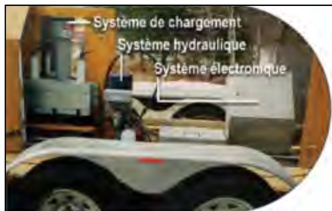
Figure 7.1 Les systèmes de FWD (MTQ, 2013)
