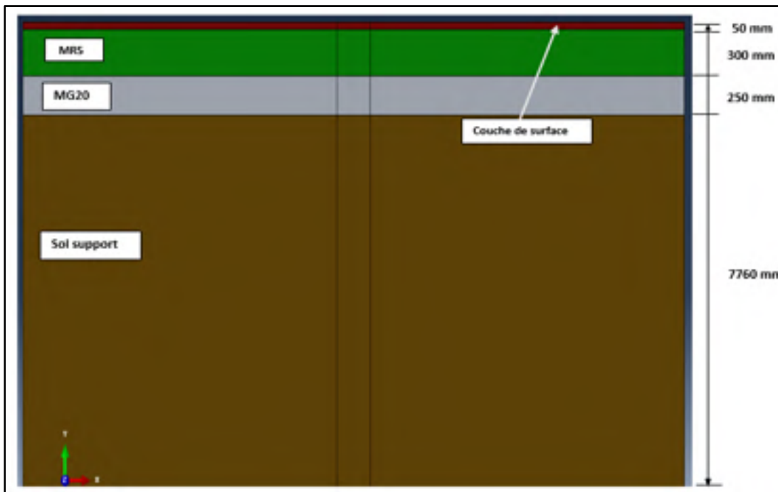
Figure 8.7 Structure réhabilitée par un retraitement type II
