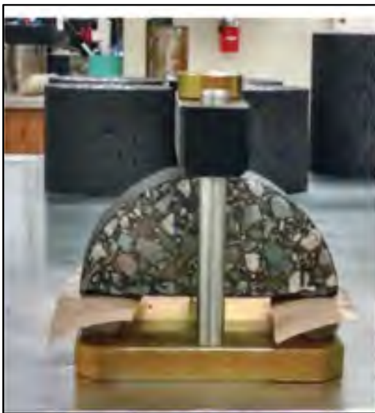
Figure 1.13 Essai de flexion semi-circulaire (ASTM, 2016)
