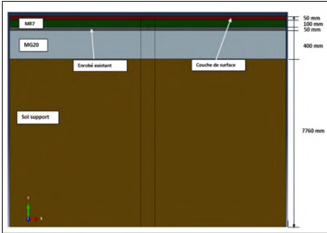
Figure 8.6 Structure réhabilitée par un retraitement type I
