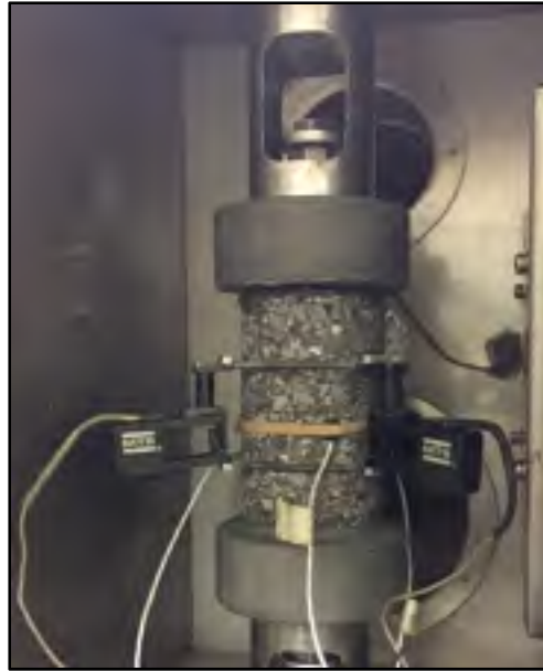
Figure 3.7 Essai de module complexe
