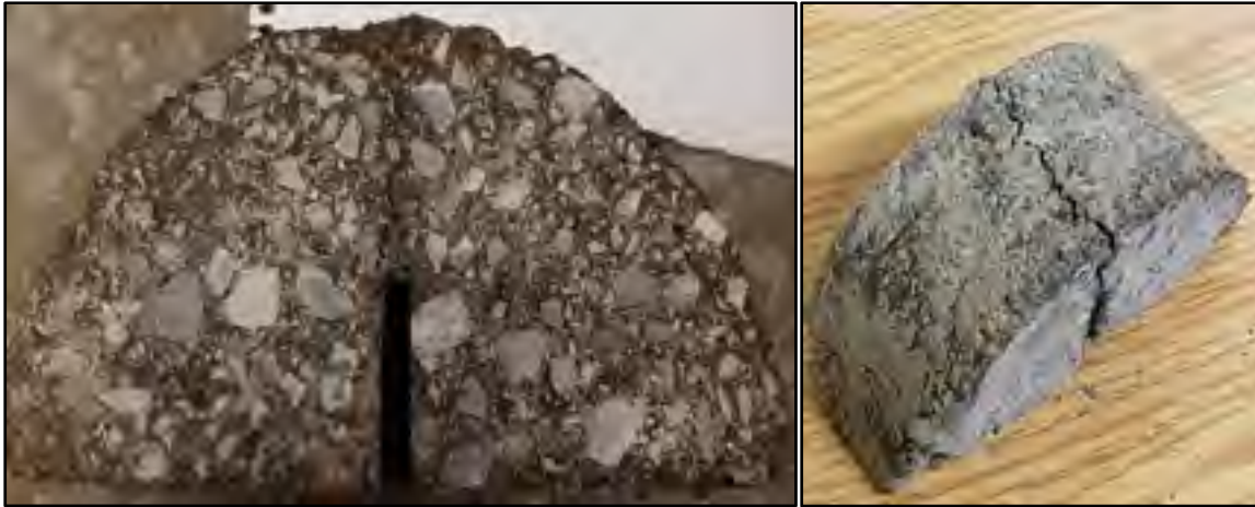
Figure 4.6 Rupture des éprouvettes de l'essai SCB
