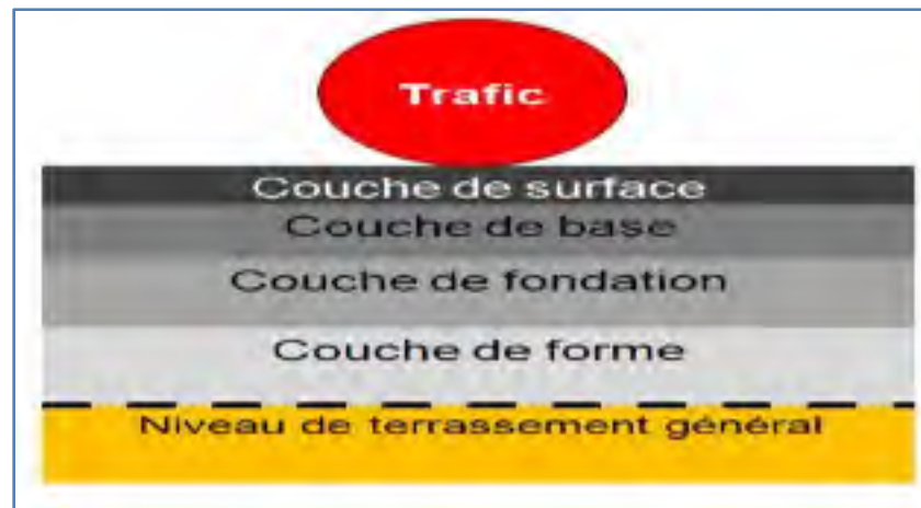
Figure 3.1 Structure-type d'une chaussée
