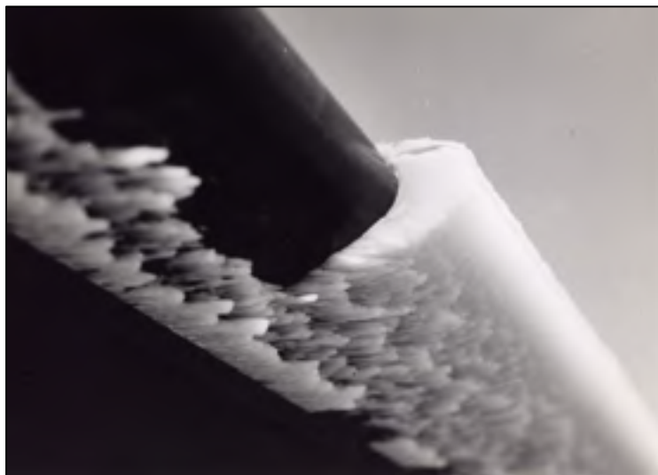
Figure 0.1 Pale d'hélicoptère contaminée par le givre Tirée de PPRuNE (2010)
