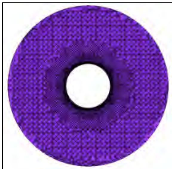
Figure 3.5 Coupe transversale du maillage du domaine farfield à Z=0
