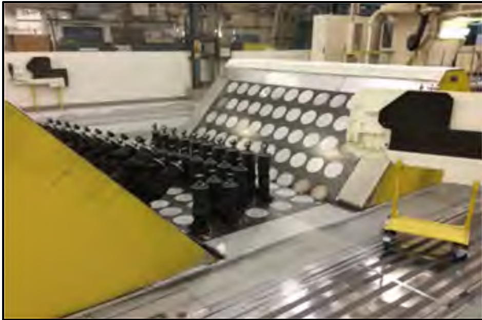
Figure 0.1 Exemple d'un système de montage flexible avec appuis ponctuels
