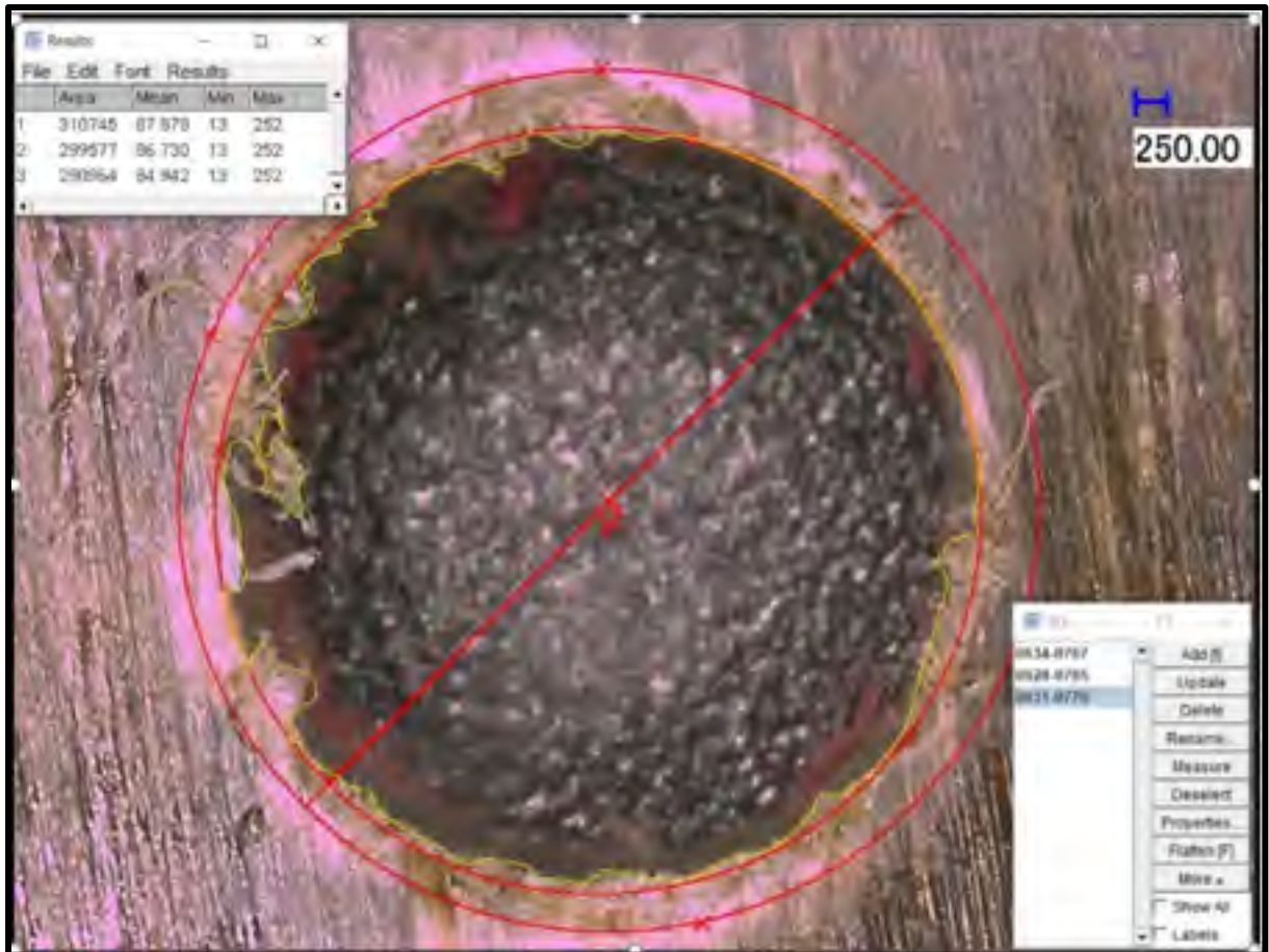
Figure 2.12 Illustration de l'analyse de pixels des fibres non coupées
