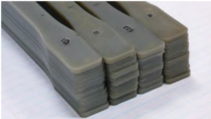
Figure 5.7 Éprouvettes injectées pour les essais de traction.
