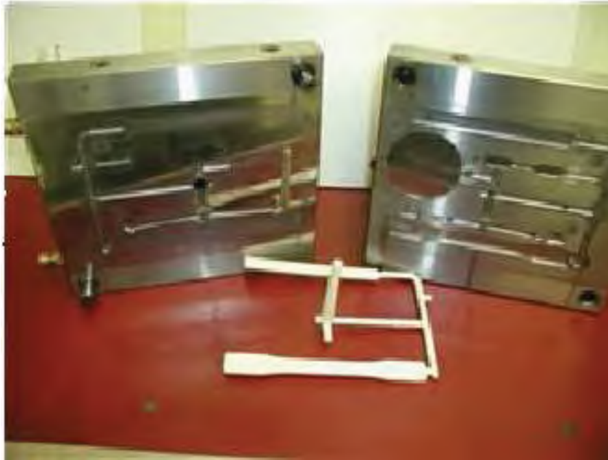
Figure 5.6 Moule pour l'injection des éprouvettes standardisées. Tirée du site Internet de l'IMI
