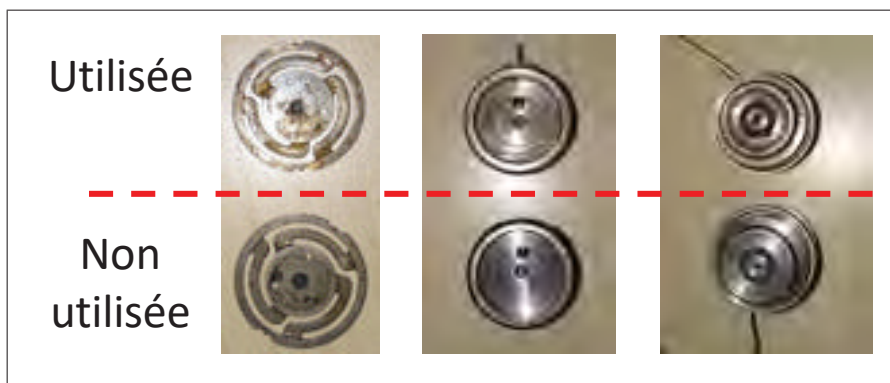
Figure 3.4 Comparaison entre une électrovalve usagée et neuve
