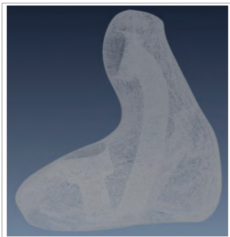
Figure 1.6 Maillage surfacique du bouchon sonde avec le passage des tubes, tirée de Paris (2018)
