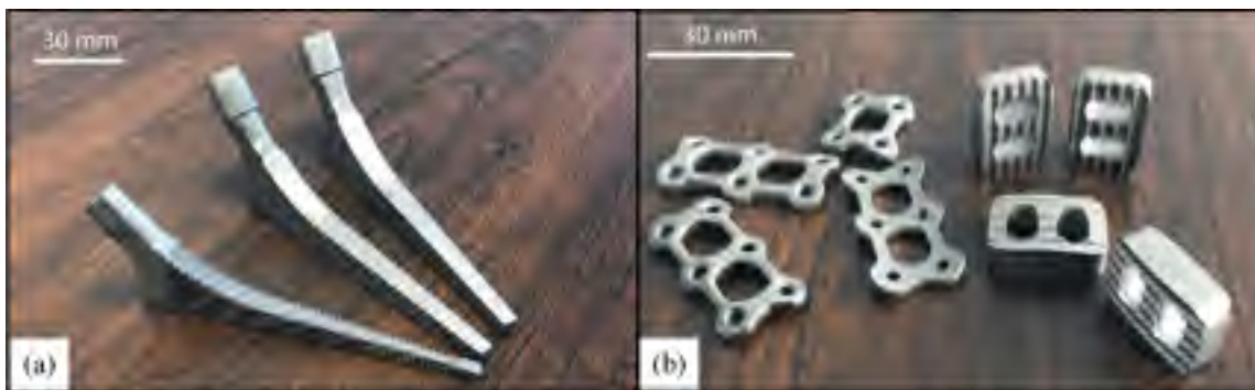
Figure 1.3 Pièces produites par LPIM: (a) implants intervertébraux et (b) composants orthodontiques (adaptée de (Demers, 2019))
