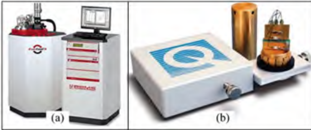
Figure 3.6 Équipements de caractérisation thermique : (a) Système de mesure de propriétés physiques et (b) configuration de transferts thermiques
