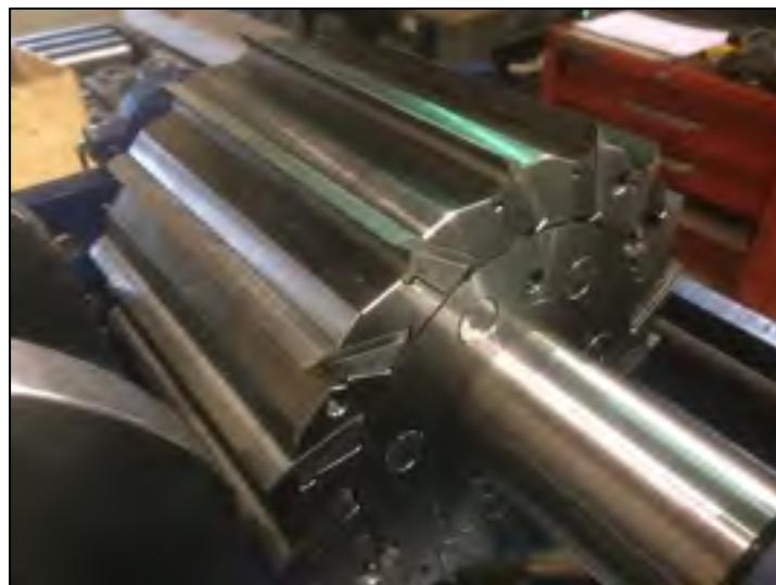
Figure 1.5 Tête d'usinage
