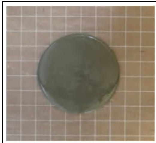
Figure-A I-5 Exemple d'étalement de la pâte après l'essai au mini cône
