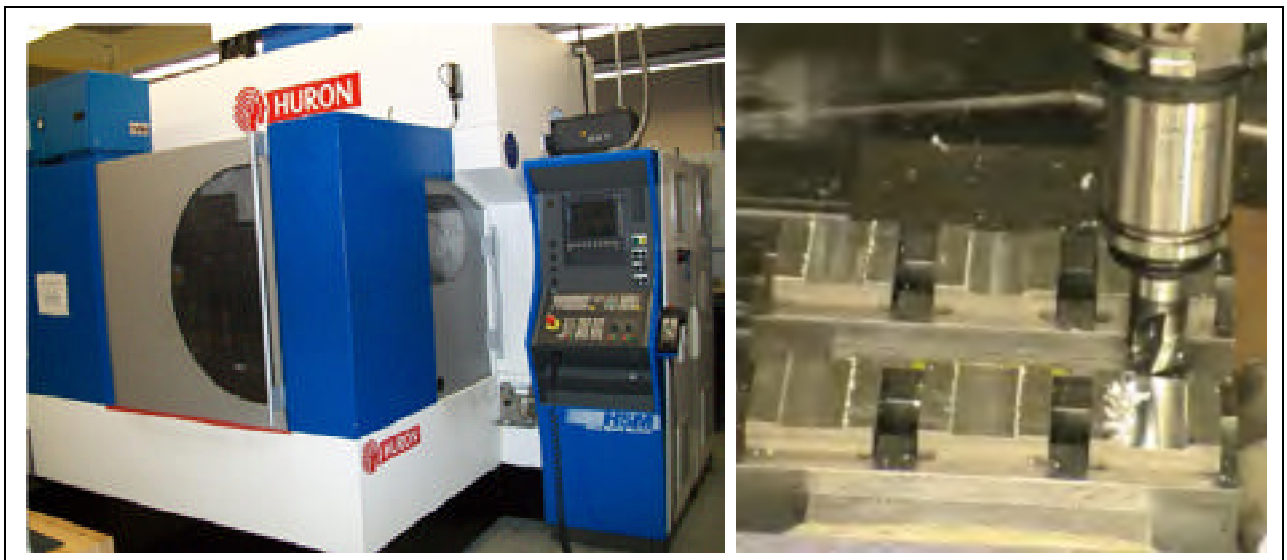
Figure 2.1 Usinage sur centre d'usinage 3 axes HURON K2X10.
