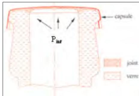
**Figure 1.36 Géométrie de la fermeture.**
