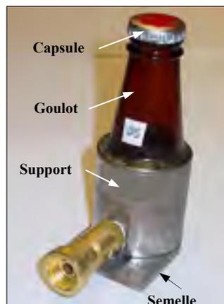
Figure 2.3 *Adaptateur de bouteille.*
