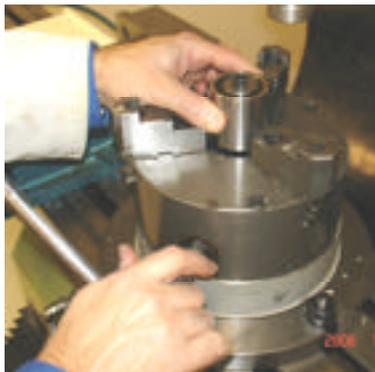
**Figure 2.4** *Fixation du support.*
