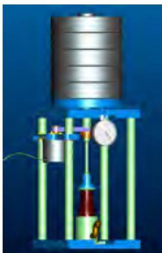
**Figure 3.3** *Dispositif avec adaptateur de capsule montée libre.*
