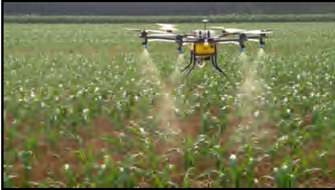
Figure 1.7 Drone pulvérisateur agricole 6L – JT6L-606 Tirée du site helsel.eu (2020) (Consulté au mois de Juin 2020)
