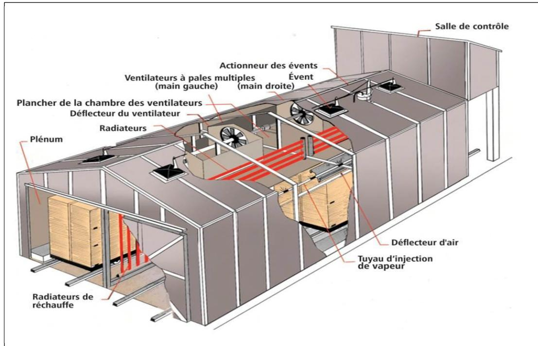
Figure 1.5 Schéma d'un séchoir conventionnel à chauffage indirect
