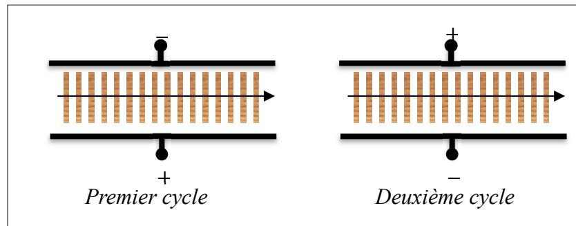
Figure 1.7 Représentation d'un four haute fréquence
