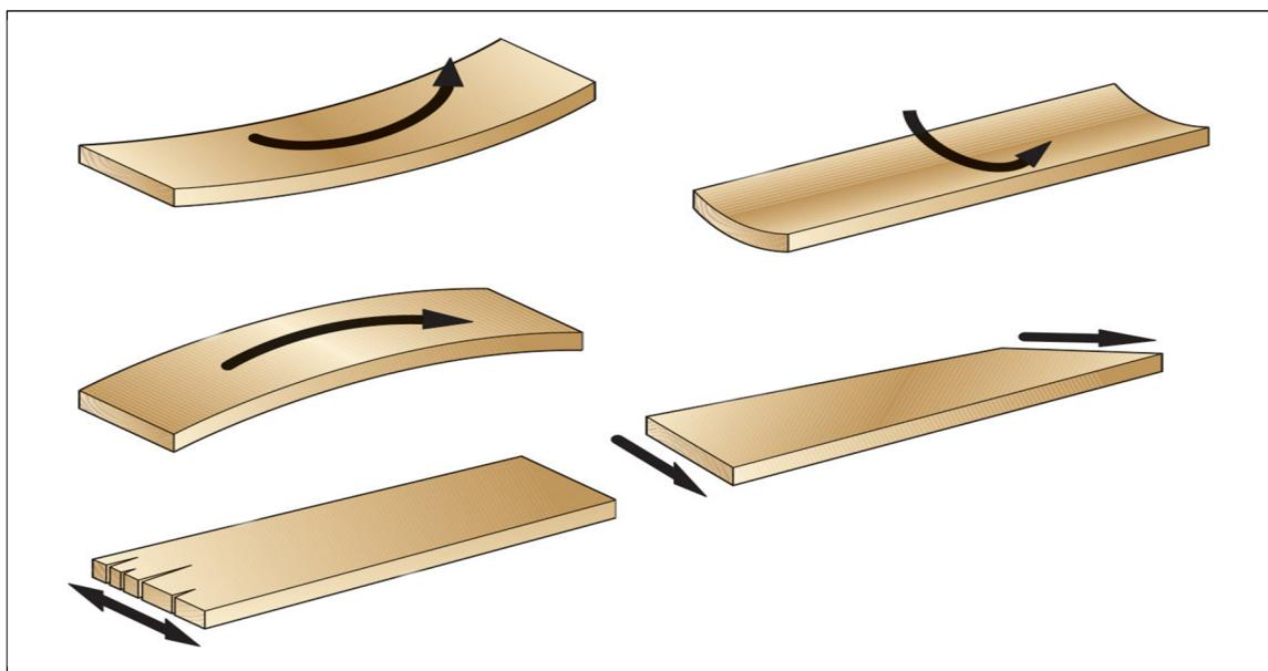
Figure 1.4 Quelques exemples de défauts de séchage
