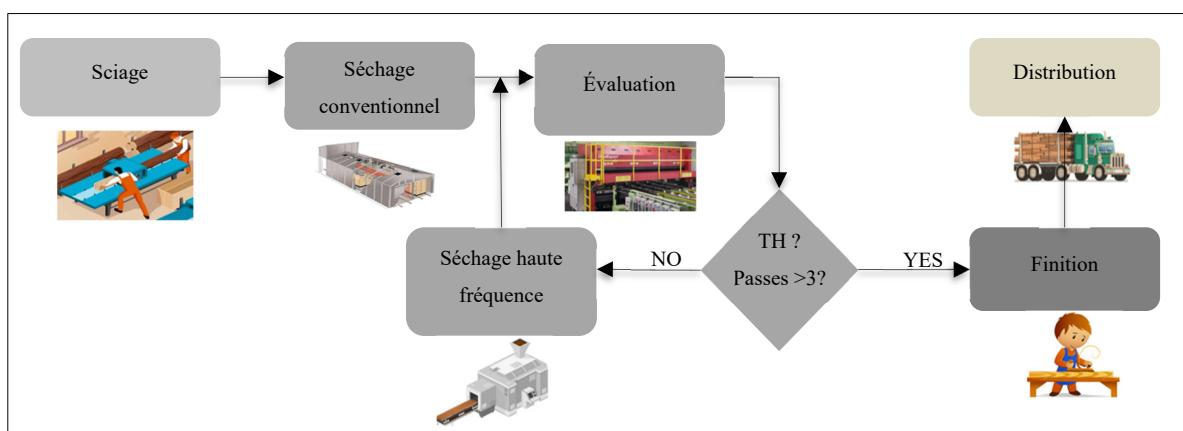
Figure 1.8 Processus de fabrication des planches de bois
