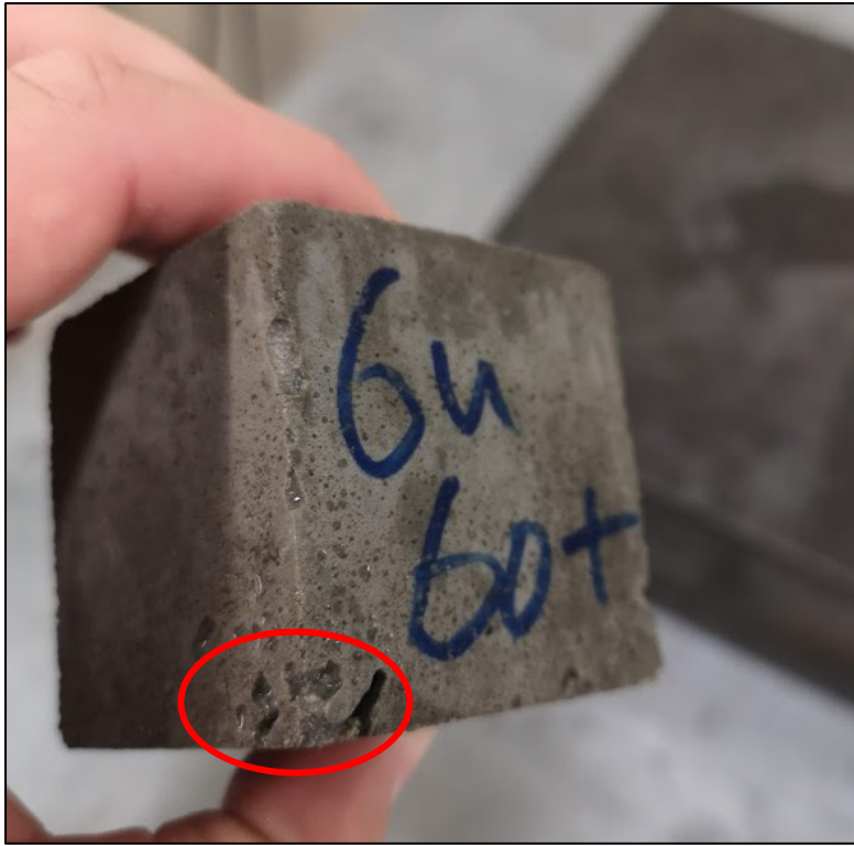
Figure 3.24 Vides causés par un mauvais compactage du mortier
