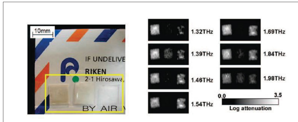
Figure 0.5 Détection de substances par les ondes THz tiré de Kawase et al. (2003).
