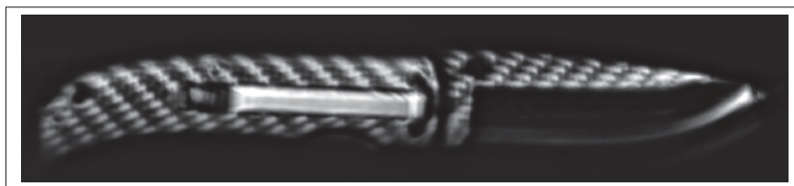
Figure 0.3 Image en réflexion d'un couteau en fibre de carbone à 2,5 THz tiré du site de la compagnie INO (2023).
