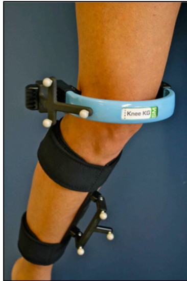
Figure 3.1 Vue antérieure d'un membre inférieur équipé du système KneeKG Tirée de Lustig, Magnussen, & Cheze, (2012, p. 635)
