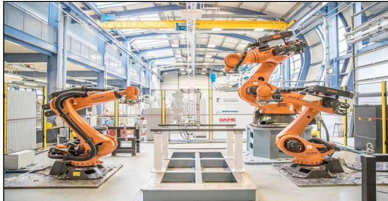
Figure 2.6 Cellule d'assemblage reconfigurable du FA 3 D Tiré de Drouot et al. (2018)
