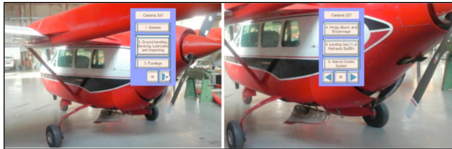
Figure 2.13 Menus mettant en œuvre le manuel de maintenance d'un Cessna 337 à travers la RA Tiré de Boisvert et al. (2020)
