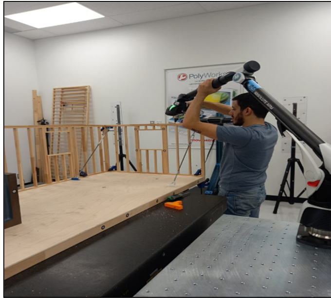
Figure 4.7 Prise de mesure avec le Absolute Arm®
