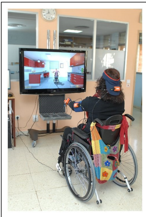
Figure 1.3 Capteurs inertiels Xsens utilisés pour la cinématique de la propulsion en FRM Tiré de Dimbwadyo Terrer et al. (2016)
