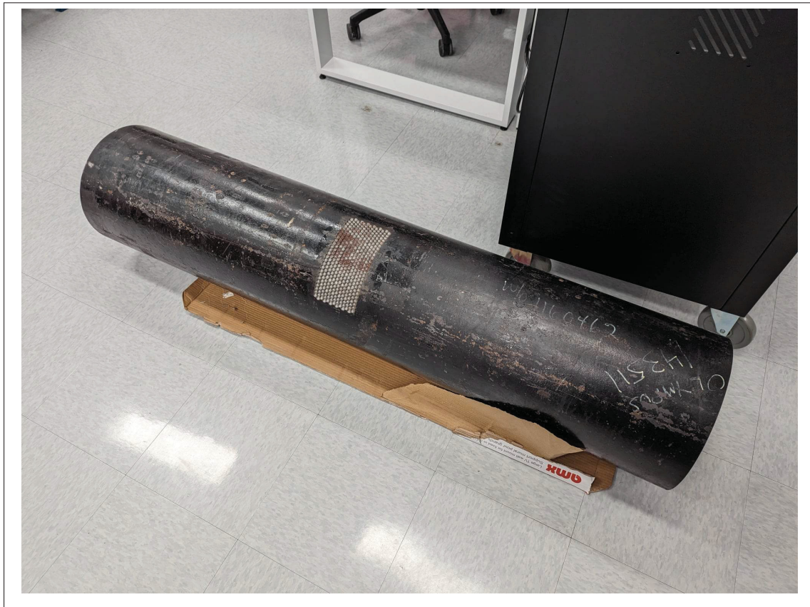
Figure 1.6 Photo du tuyau utilisé lors de cette thèse avec une épaisseur de 10.2 mm et un diamètre extérieur de 323.8 mm
