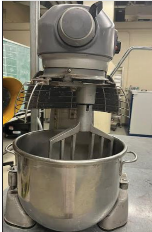
Figure 2.10 Malaxeur du mélange des composants de remblai
