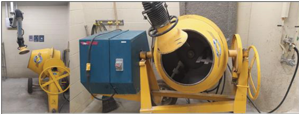
Figure 2.7 Bétonnière à tambour rotatif utilisé pendant les essais à l'ÉTS
