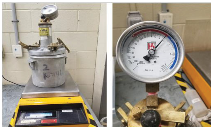
Figure 2.15 Mesure de la teneur en air du béton frais
