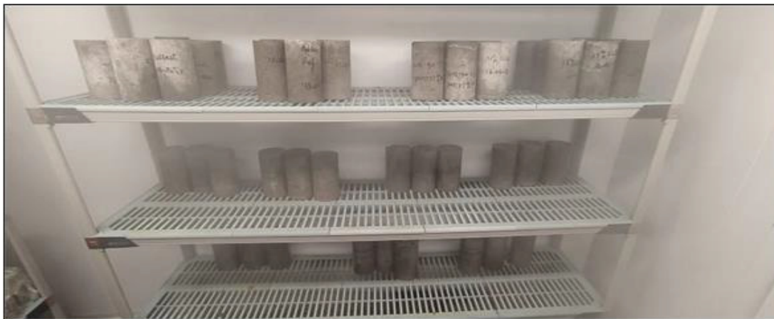
Figure 2.12 Chambre humide pour des temps de cure des échantillons de béton avant les mesures de résistances à la compression
