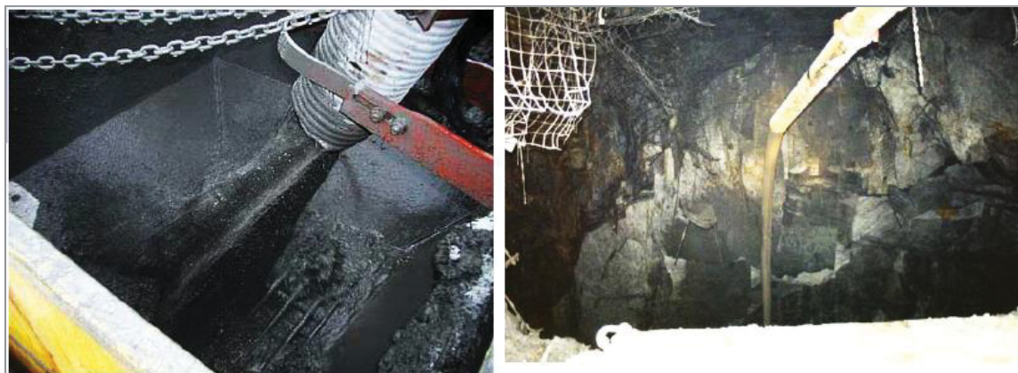
Figure 1.9 Photos de remblai hydraulique, tiré du cours GML1002 par Tikou Belem, (2017, p.13)
