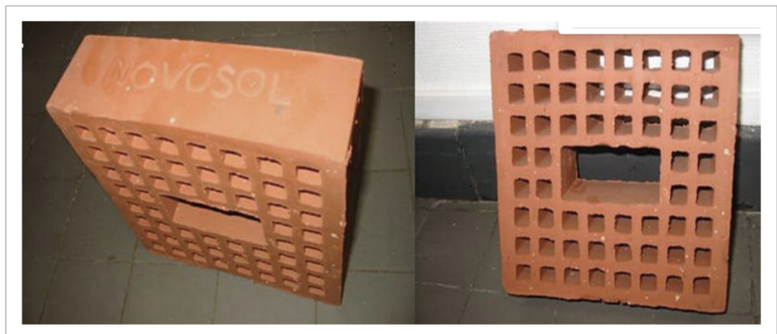
Figure 1.10 Briques fabriquées avec les sédiments Tirée de Samara (2007)
