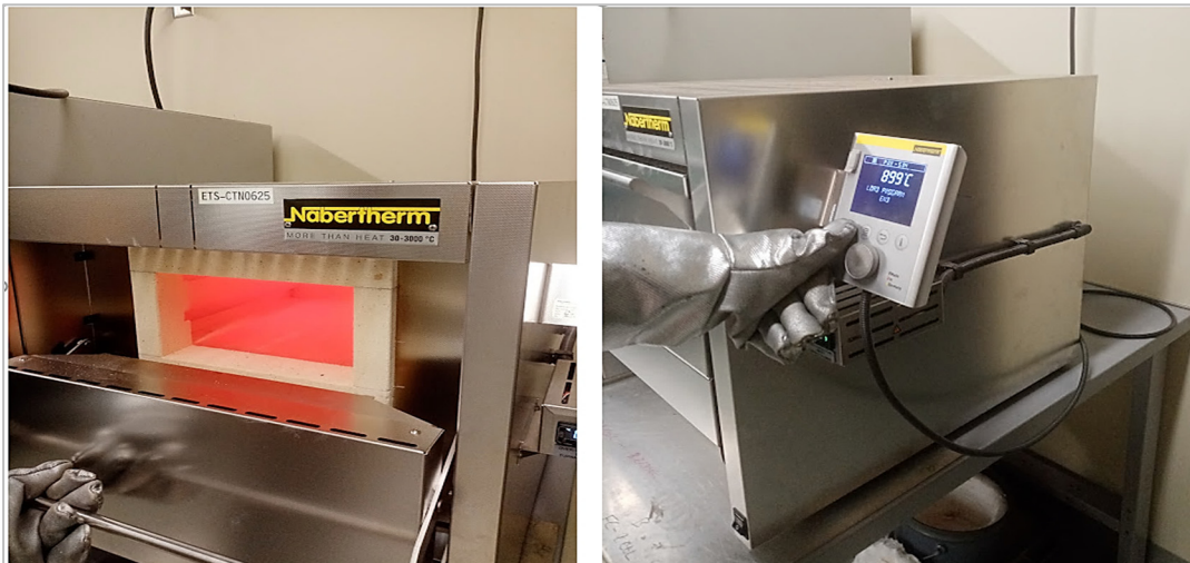
Figure 2.13 Fours moufle utilisés pour la calcination à l'ÉTS
