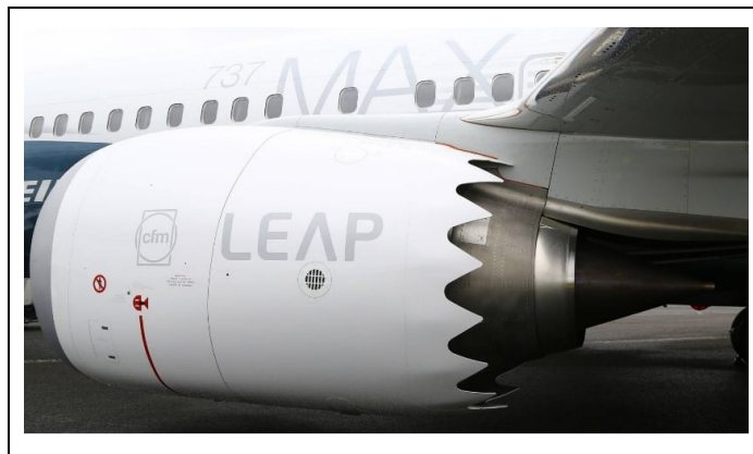
Figure 1.13 Photographie de chevrons sur un LEAP-1B du Boeing 737 MAX
