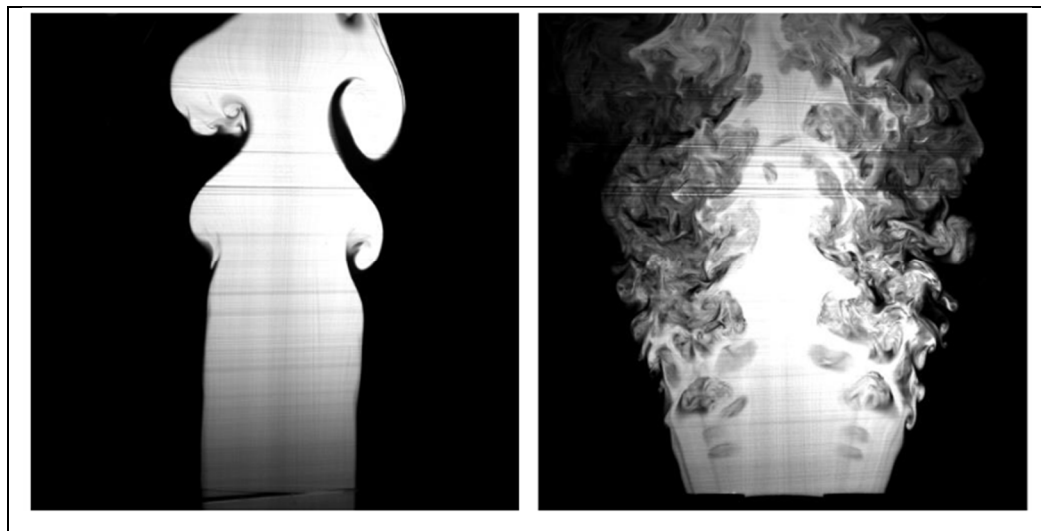
Figure 1.18 Visualisation laser d'un jet simple et d'un jet avec mélangeur lobé Tirée de Hu et al. (2000, p.700-702)
