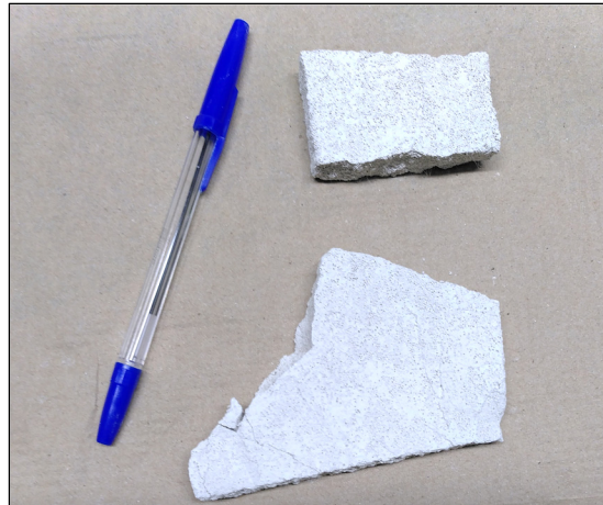
Figure-A I-1 Morceaux de panneaux de gypse de diamètre inférieur à 100 mm et dépourvus d'enveloppe papier
