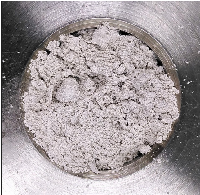
Figure-A I-5 Poudre de gypse obtenue après réalisation des cinq étapes
