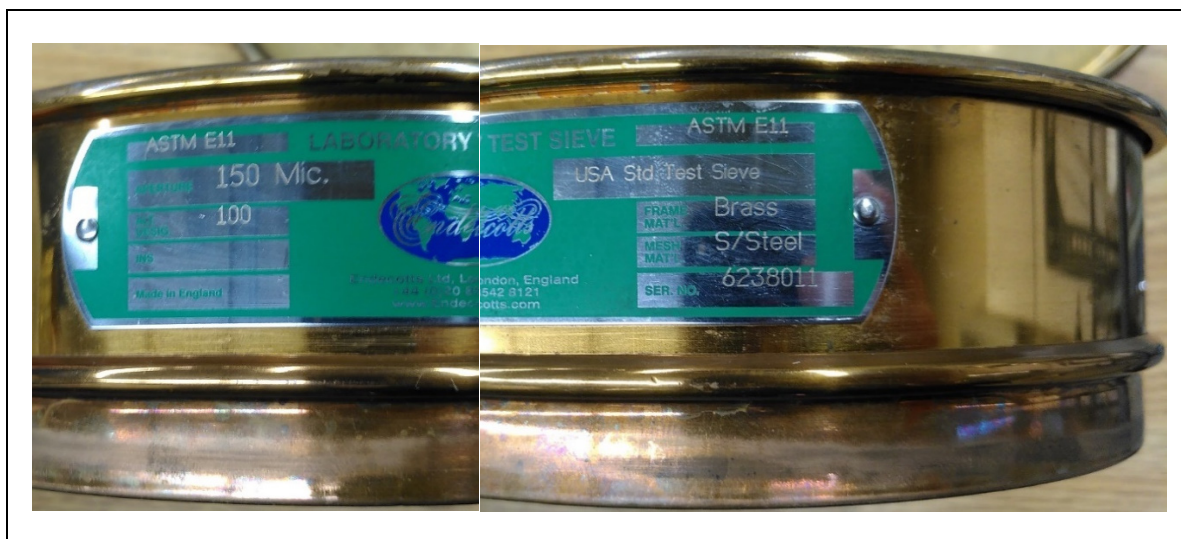
Figure-A I-4 Tamis 150 µm utilisé pour tamiser la poudre
