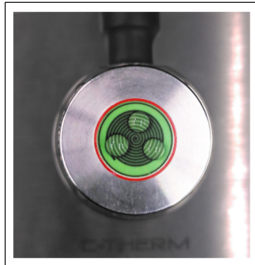
Figure 4.9 Photo du MTPS avec trois gouttes d'eau
