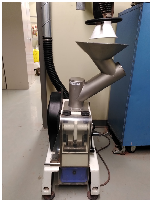
Figure-A I-2 Photo du concasseur à mâchoire utilisé pour le premier broyage
