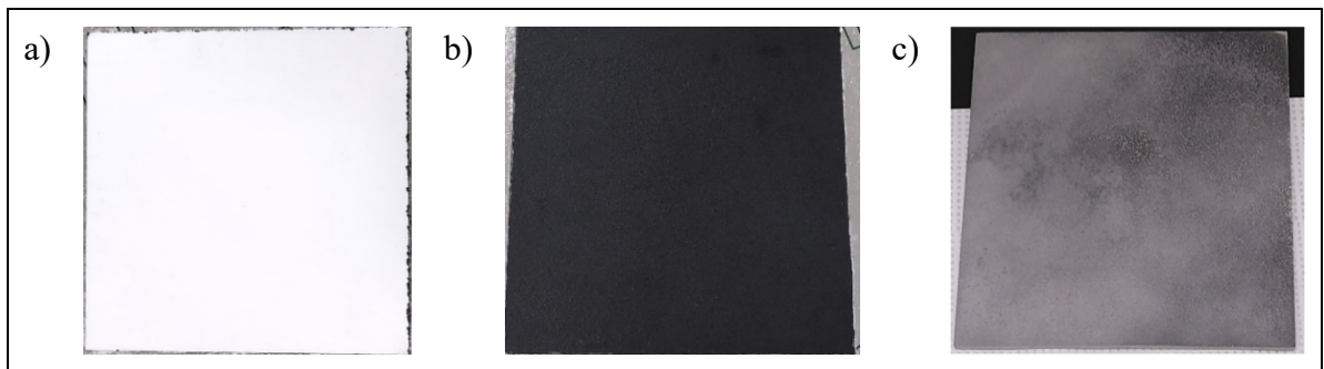
Figure-A III-1 a) Photo d'un carré du composite recouvert de peinture blanche ; b) photo d'un carré de composite recouvert de peinture noire ; c) photo d'un carré de composite dont la peinture noire a été poncée
