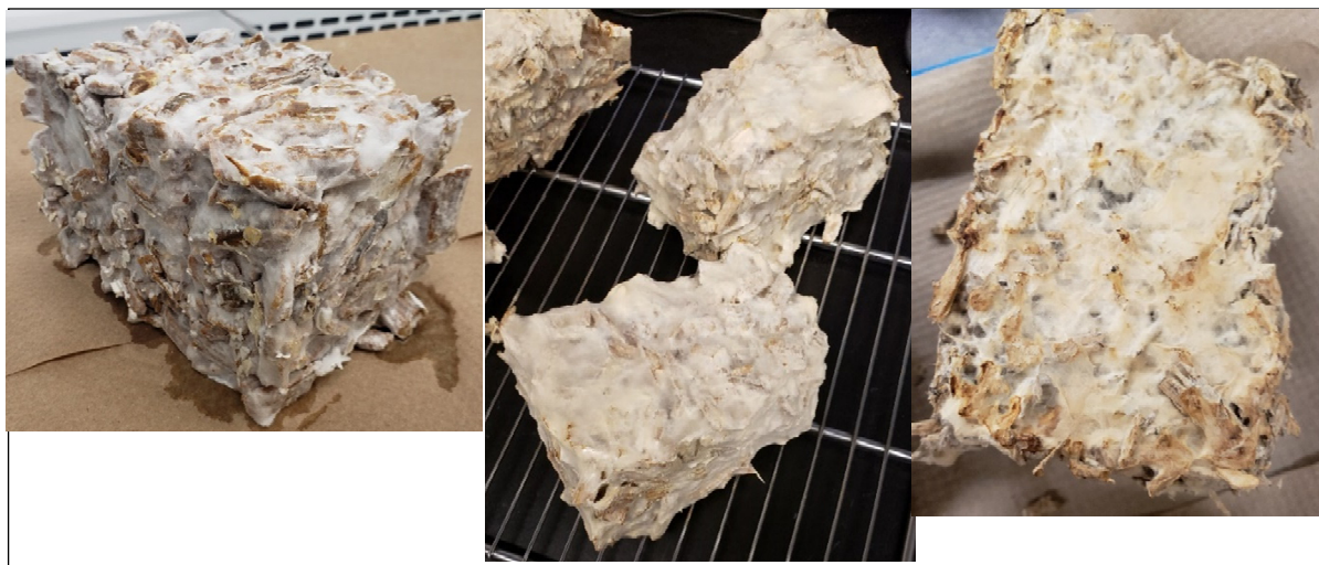
Figure A I-4 Briques de mycélium de Pleurotus ostreatus , de grains de seigle et de copeaux de frêne a) avant séchage, b) pendant séchage et c) après séchage à 80°C pendant 24 heures
