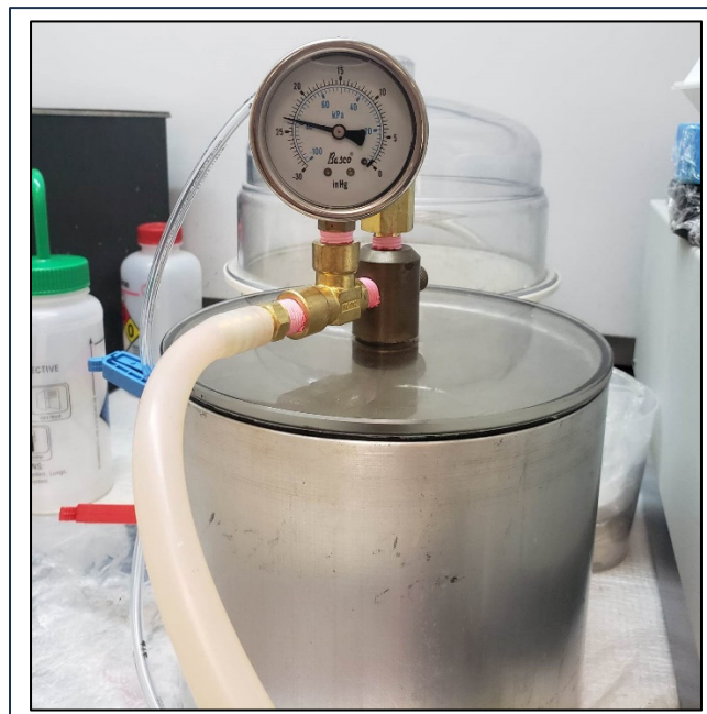
Figure 2.5 Système utilisé pour la mise à vide des échantillons d'isolant afin de déterminer le volume des pores
