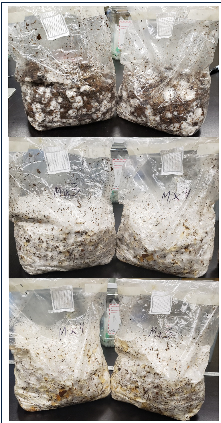
Figure A I-3 Croissance du mycélium de Pleurotus ostreatus sur copeaux de seigle avec un inoculum de 10% de grains de seigle colonisés après a) 2 jours, b) 10 jours et c) 14 jours
