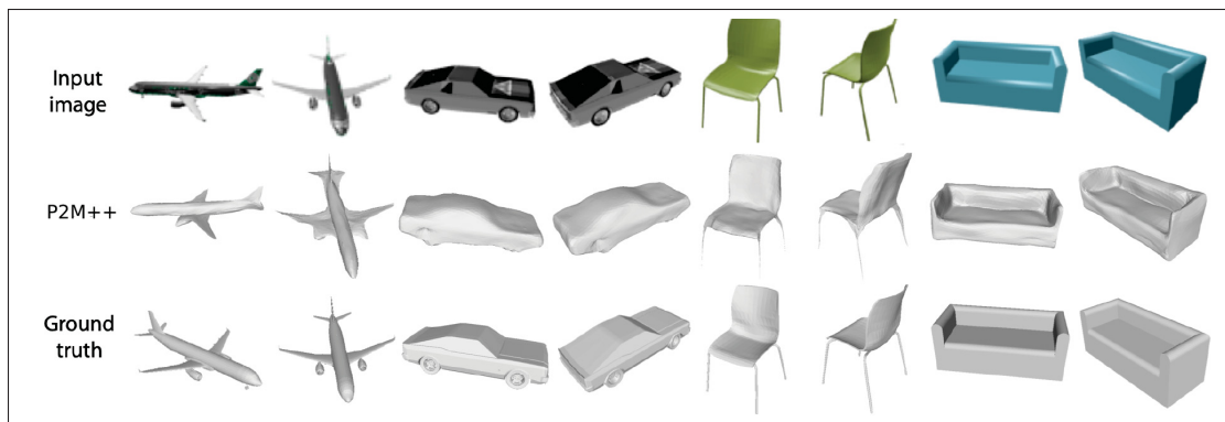
Figure 2.10 Résultats qualitatifs obtenus sur 4 classes d'objets lorsque deux images sont utilisées. La première rangée présente les images données en entrée au réseau de neurones, la rangée du milieu la sortie du réseau et la rangée du bas les modèles de référence. Les colonnes (1,2), (3,4), (5,6) et (7,8) représentent quatre reconstructions présentées sous deux points de vue différents, obtenues à l'aide des deux images de la première rangée Modifiée de Wen et al. (2019)
