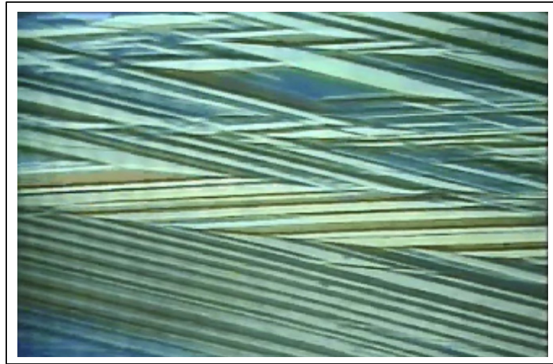
Figure 1.9 Exemple de macles formées pendant la transformation martensitique Tiré de reportage TV5
