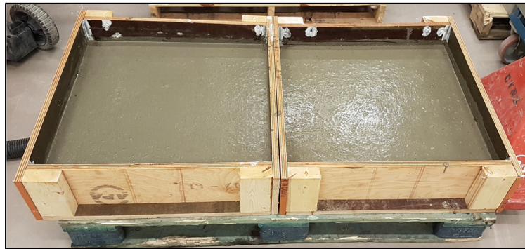
Figure A I-2 Bétonnage des modèles physiques
