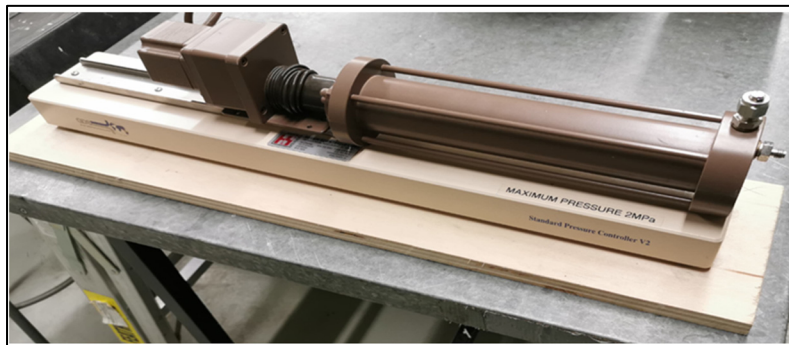
Figure A I-4 Contrôleur pression-volume de la marque GDS
