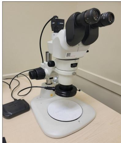
Figure 3.7 Stéréoscope utilisé pour la visualisation des angles de surplomb
