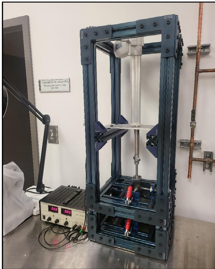
Figure 3.8 Presse à injection pour fabriquer les tiges de l'imprimante commerciale
