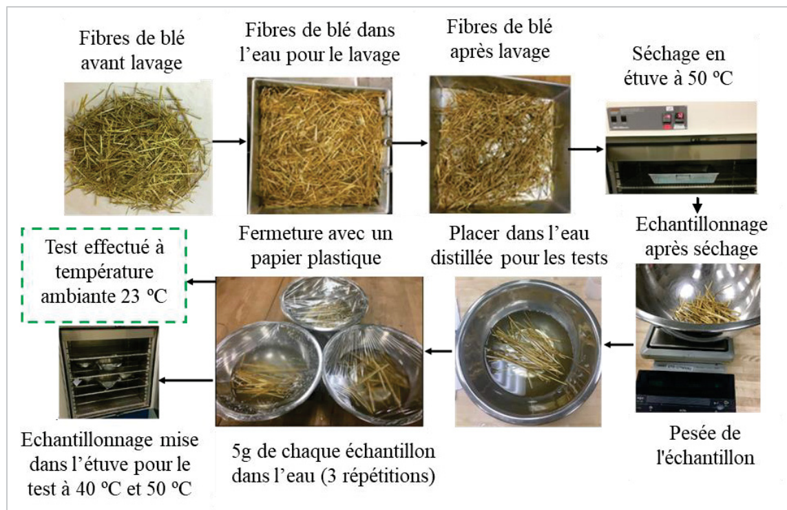
Figure 2.9 Étapes pour l'essai d'absorption d'eau à température de 23 °C, 40 °C et 50 °C
