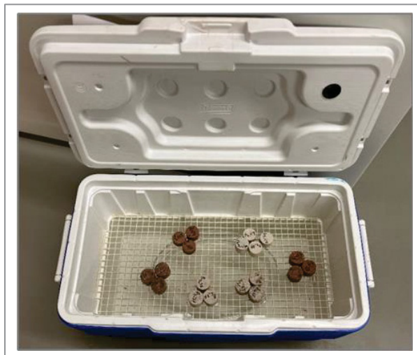
Figure 2.17 Test de risque de moisissure
