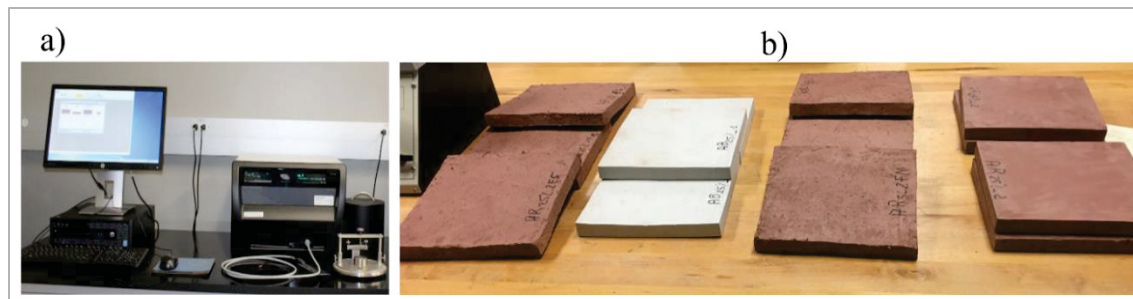
Figure 2.14 Appareil TPS 3500 et échantillons d'essai au SEREX
