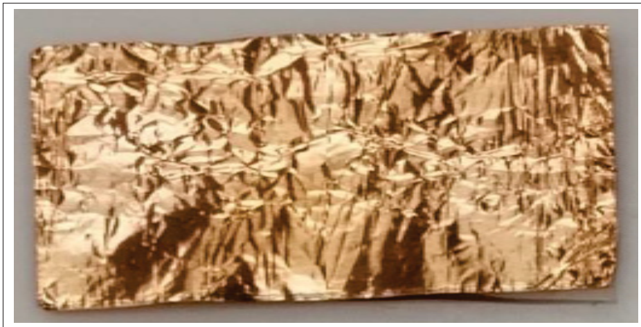
Figure 3.3 Plan de masse utilisant du ruban adhésif en cuivre après quelques manipulations et essais de pliage
