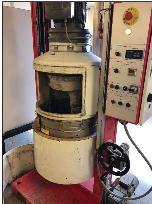
Figure 3.4 Malaxeurs thermo-régulés, de Capacité de 80 kg, utilisé pour la confection de l'EME-14 Lieu : CTA à Brossard
