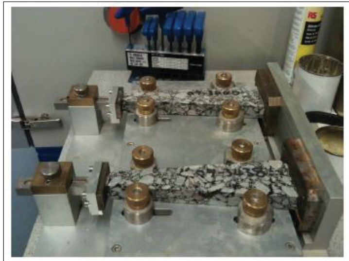
Figure 3.16 Gabarit pour le collage d'échantillons trapézoïdaux sur les plaques d'extrémité d'un appareil de flexion à deux points Tirée de Maggiore (2012, p. 76)
