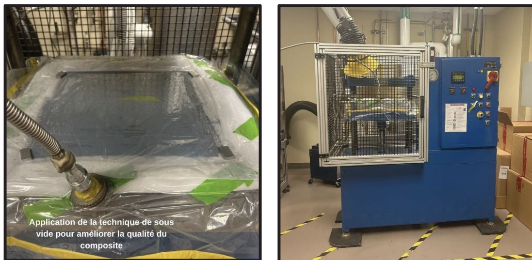
Figure 2.8 Application du sous-vide et processus de durcissement sous presse
