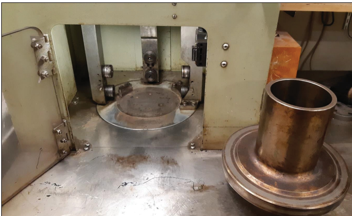
Figure 2.2 Presse à cisaillement giratoire vide avec un moule de 100 mm de diamètre
