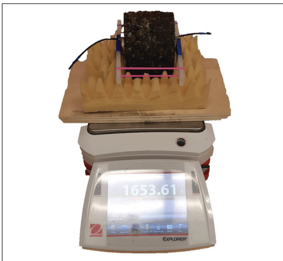
Figure 2.19 Montage expérimental. Le spécimen reposant sur la mousse est instrumenté avec le couple de transducteurs 26-22 mm A
