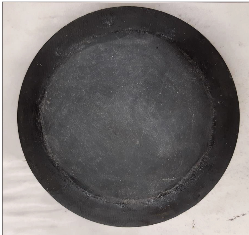
Figure 2.8 Moule de 15 mm avec mastic bitumineux recouvert d'une fine couche d'argile broyée
