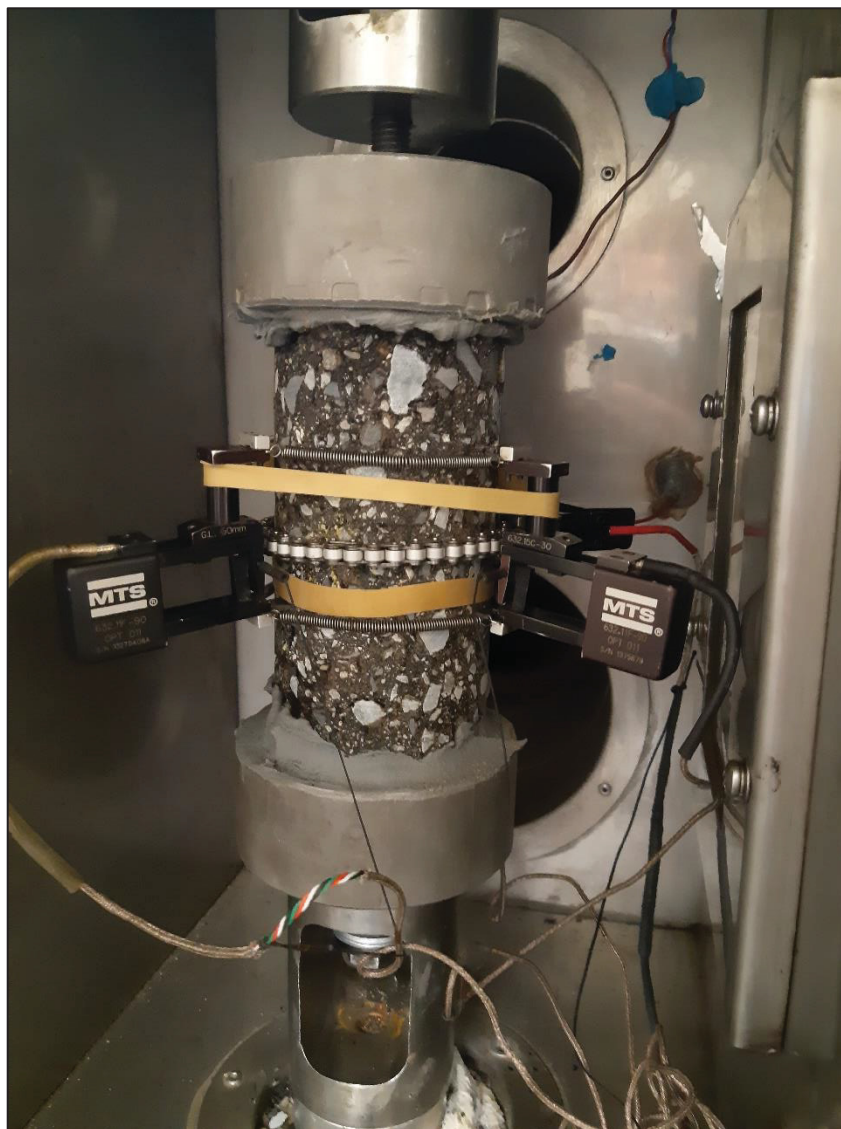
Figure 2.24 Spécimen 3 installé dans la chambre thermique de la presse MTS et instrumenté, avant essai
