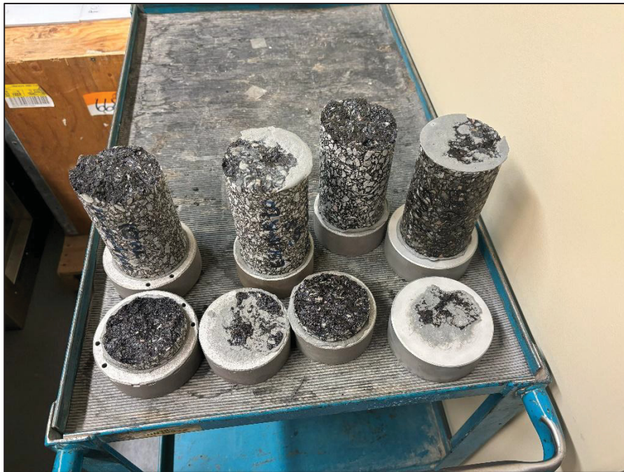
Figure 8.2 Photos des éprouvettes après l'essai TD
