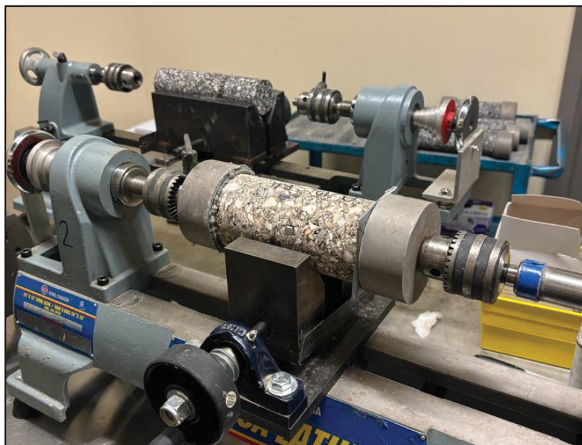
Figure 3.21 Photo de collage d'un casque sur l'éprouvette à l'aide du banc
