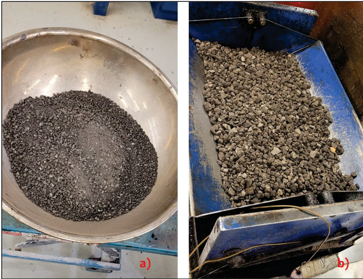
Figure 3.2 Photos des deux classes granulaires issues de la séparation du GBR 0-10 mm a) GBR 0-5 mm b) GBR 5-10 mm
