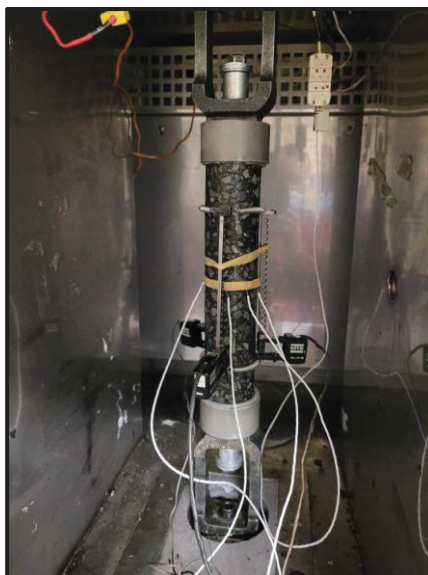
Figure 3.13 Photo d'une éprouvette instrumentée et prête pour l'essai ET
