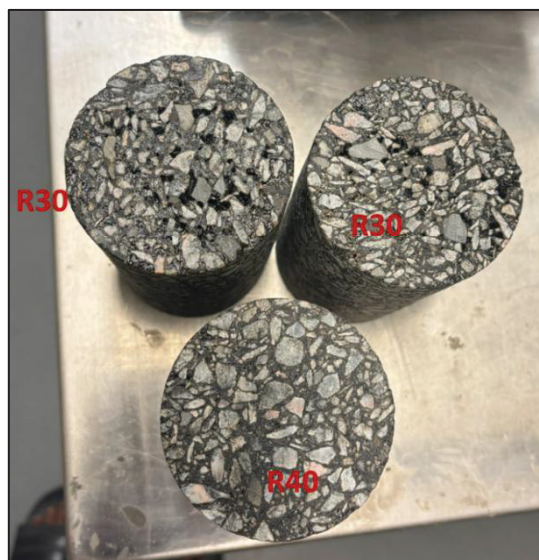
Figure 5.10 Photos des éprouvettes d'essai TD des enrobés R30 et R40
