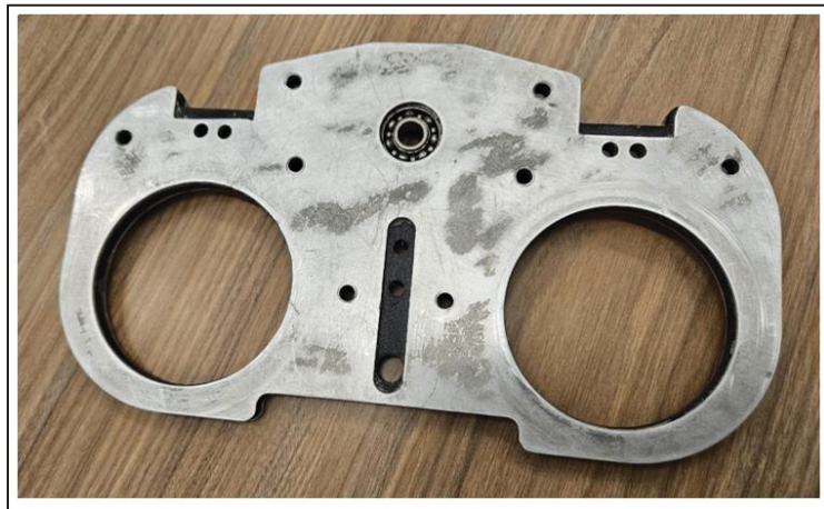
Figure 2.9 Panneau structural du mécanisme d'actionnement original
