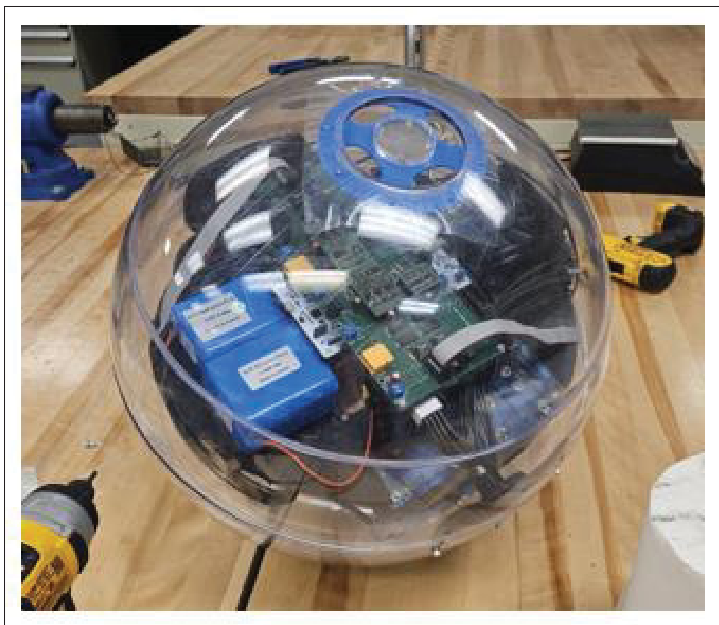
Figure 3.29 Solution envisagée pour le transfert étanche d'énergie entre la sphère et le sol
