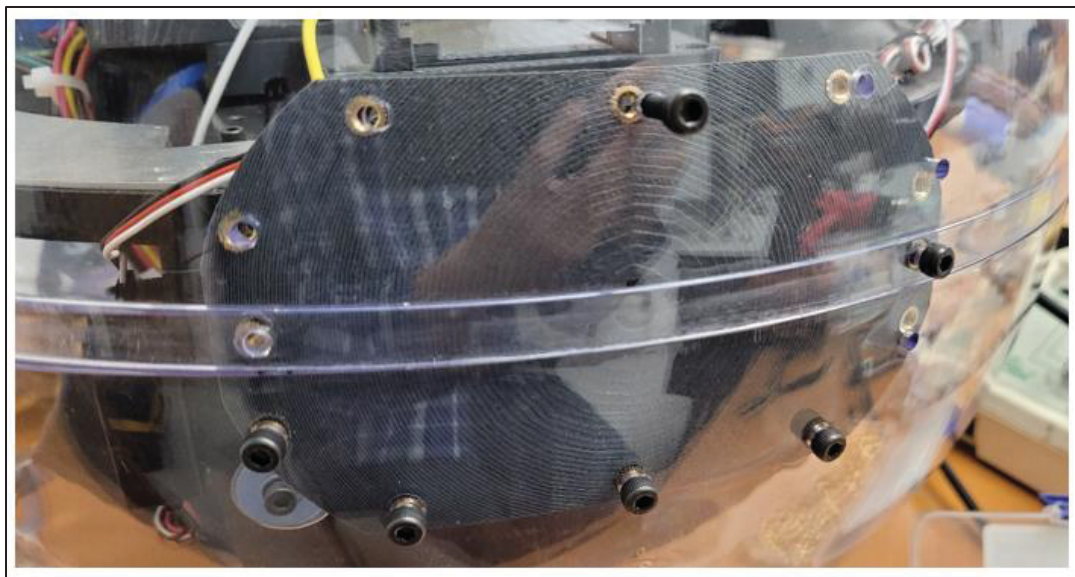
Figure-A I-4 Mauvais alignement des trous entre l'attache et la coquille
