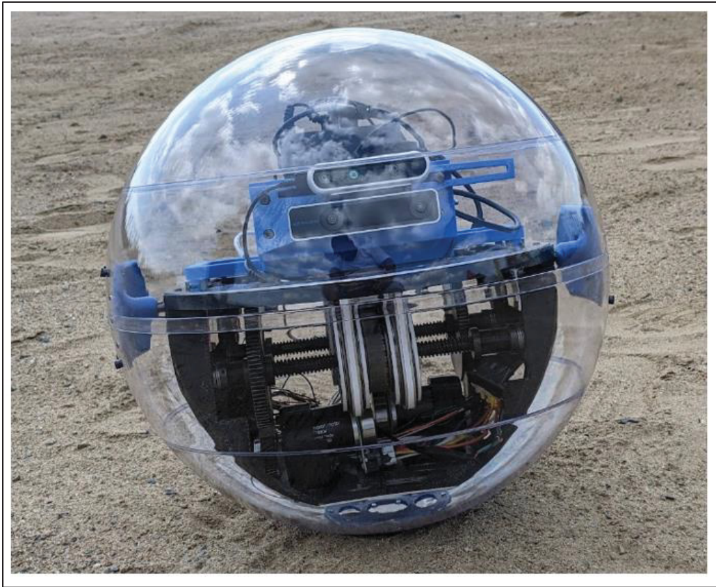
Figure 2.5 Robot sphérique ARIES actionné par un mécanisme différentiel à actionnement cylindrique
