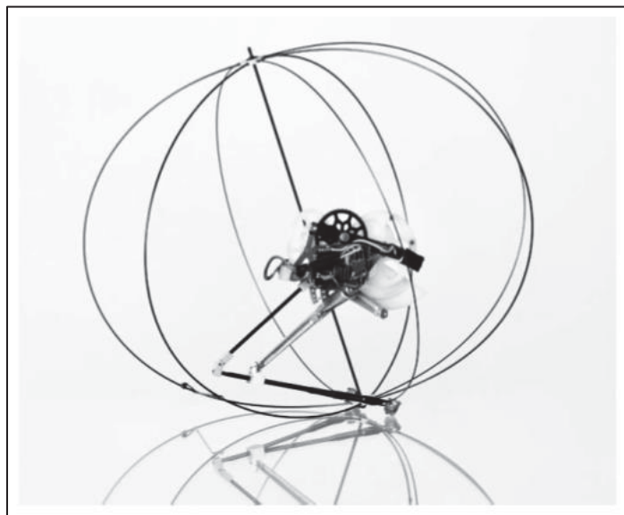
Figure 1.13 Robot sauteur bio-inspiré avec structure de protection et réorientation
