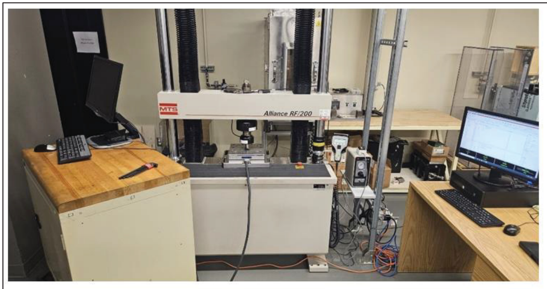
Figure-A VI-1 Montage pour la calibration statique de la table de force
