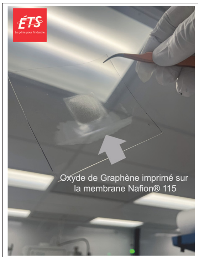
Figure 0.6 Membrane composite Nafion®, l'oxyde de graphène est imprimé sur une zone active de 40 mm 2 au centre de celle-ci
