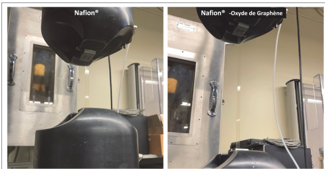
Figure 3.14 Essai de traction sur un échantillon témoin représentatif (à gauche) et sur un échantillon de Nafion® contenant du GO
