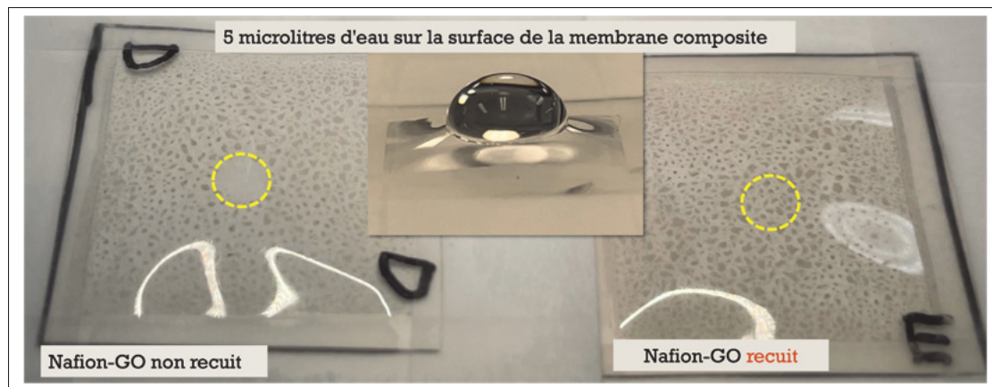
Figure 3.9 Photographie des membranes composites non recuites (à gauche) et recuites (à droite) après le test d'angle de contact. La permanence de la couche de GO est visible sur l'échantillon recuite
