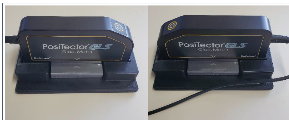
Figure 2.16 Mesures de la réflectivité dans des directions opposées sur un même gabarit
