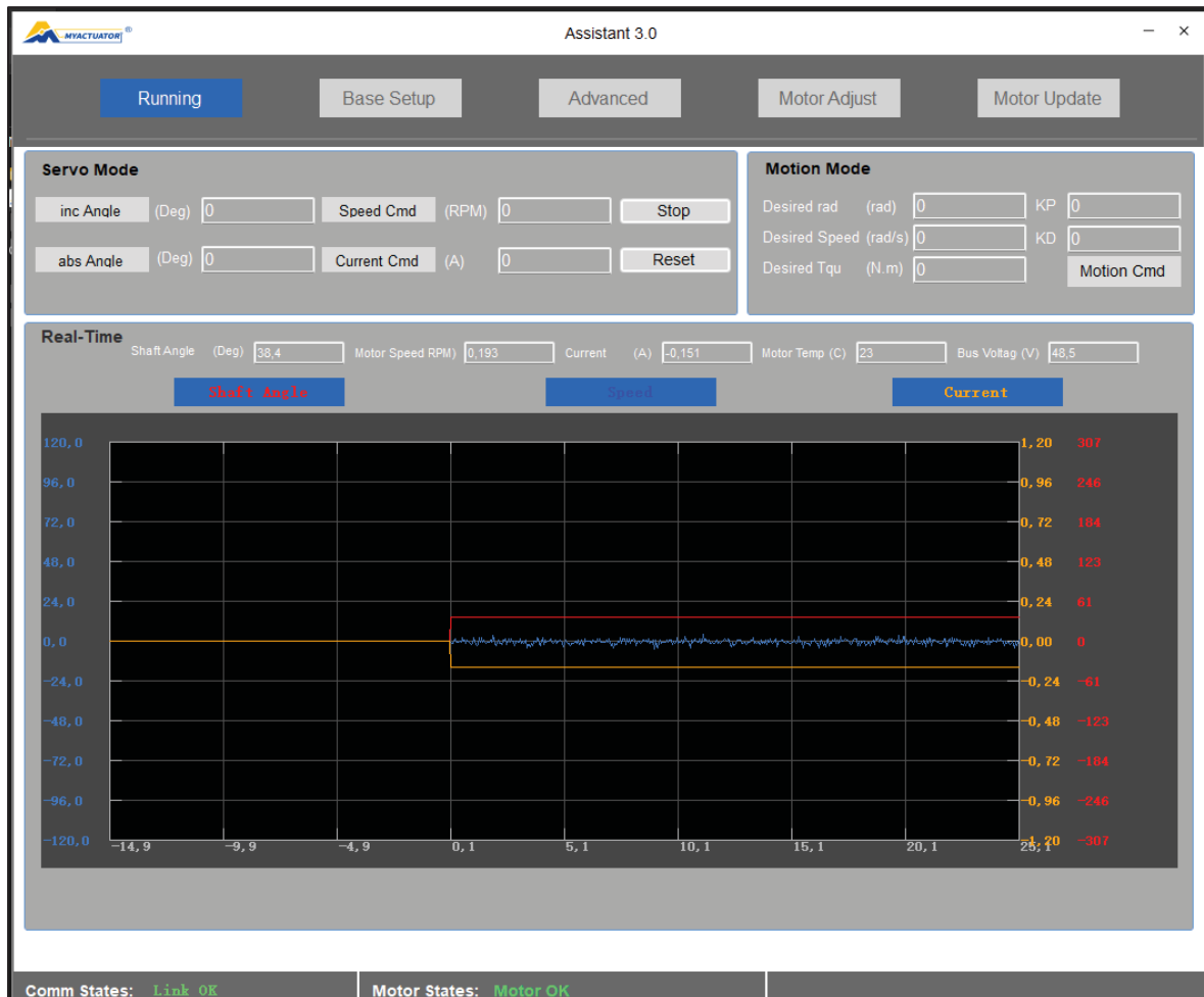
Figure-A-X-1 Interface du logiciel MyActuator affichant la position en temps réel du moteur
