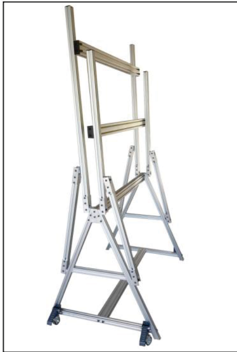
Figure 5.3 Cage de sécurité réutilisée pour fixer et protéger le simulateur lors des tests
