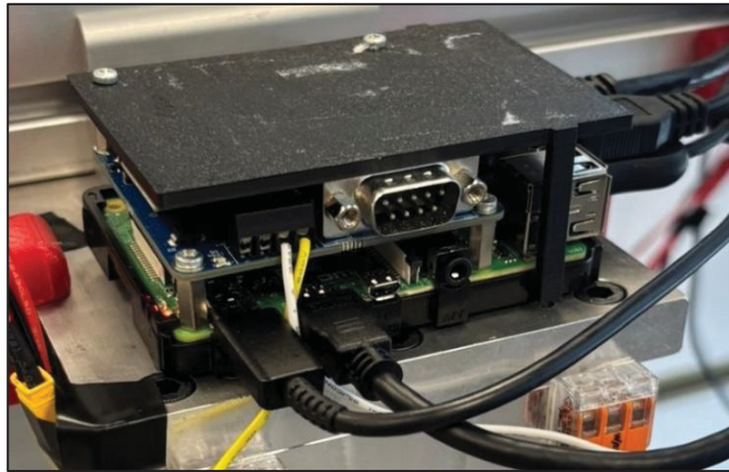
Figure 5.10 Raspberry Pi 4 modèle B avec module PiCAN3
