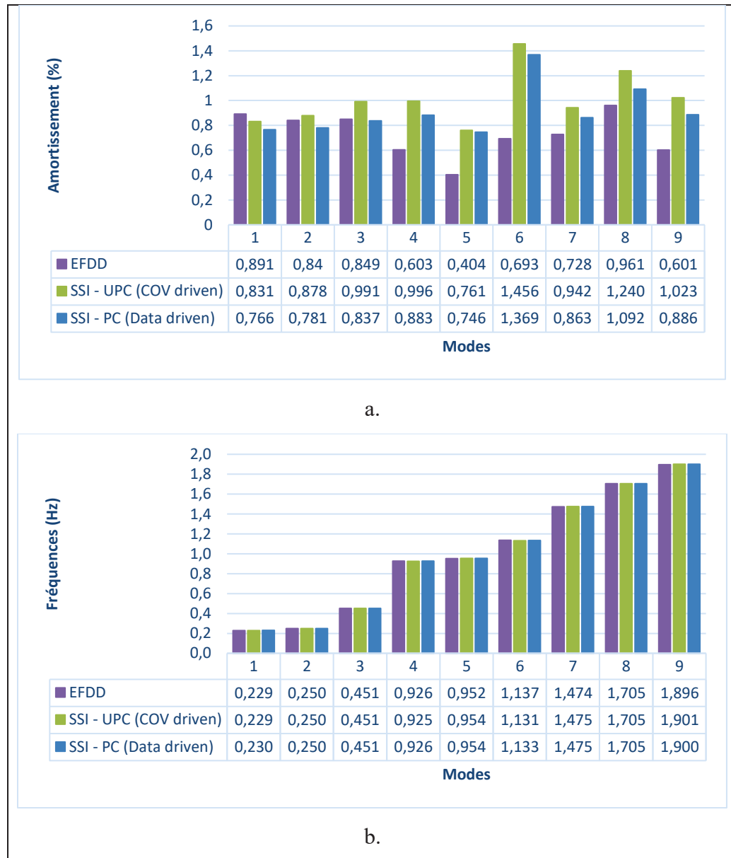
Figure 2.9 Résultats expérimentaux de l'analyse modale : a) Amortissement (en %) et b) Fréquence (Hz) en fonction des modes
