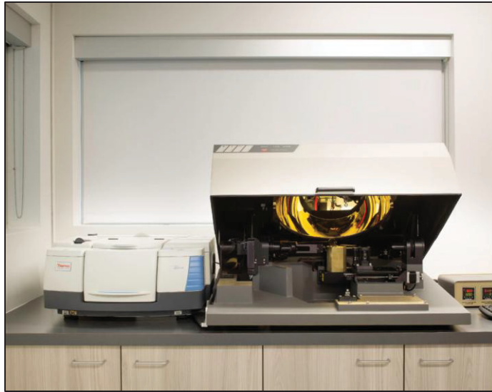
Figure-A I-3 Appareil de mesure IR (SOC 100)
