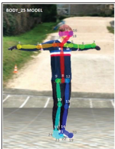
Figure 1.5 Estimation de la pose humaine à l'aide du modèle BODY_25 par défaut d'OpenPose
