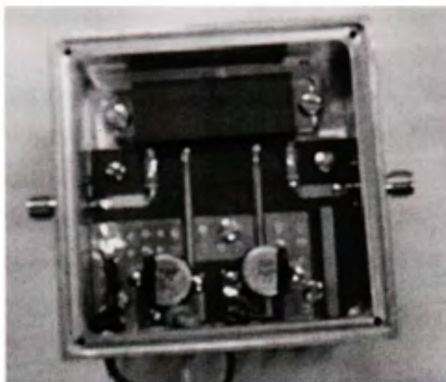
Figure 6.17 Photo de l'amplificateur de puissance de 10 watts.
