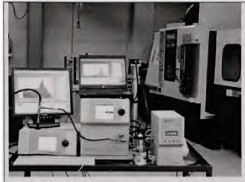
**Figure 2.3** Montage expérimental de l'APS couplé à l'SMPS
