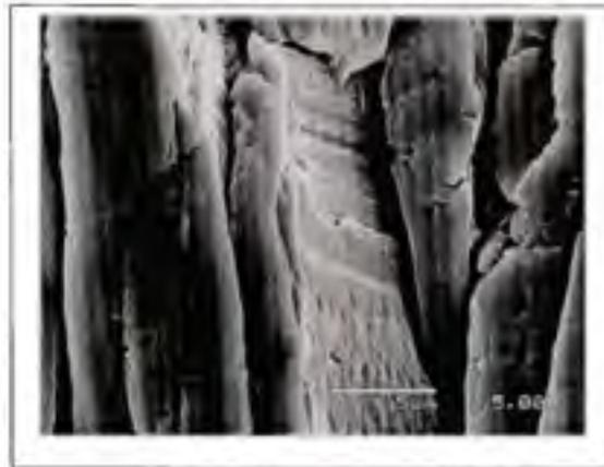
**Figure 1.10** Illustration SEM de la face extérieure du copeau.
