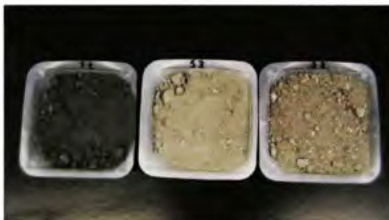
Figure 2.2 Photos des scories FAÉ, HF et FP.
