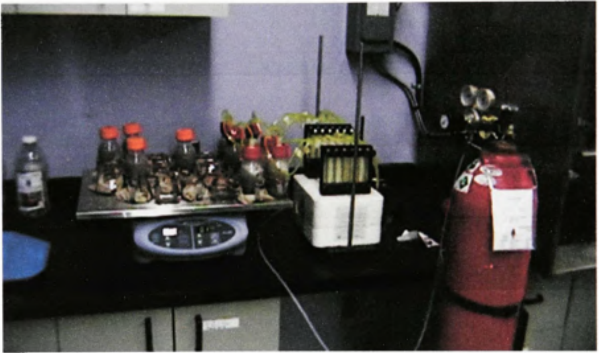
Figure A8.1 Photo du montage des essais en cuvée.
