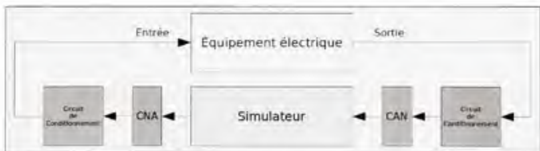
Figure 0.1 Configuration de base d'une HILS.
