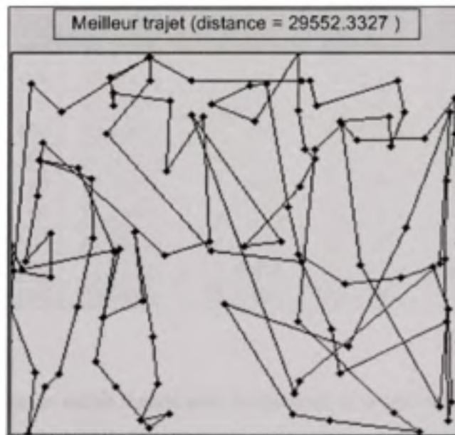
**Figure 5.2** Problème du voyageur de commerce KROA100 (algorithme de recuit simulé avec 2-opt, choix de la température égale à 100 unités).
