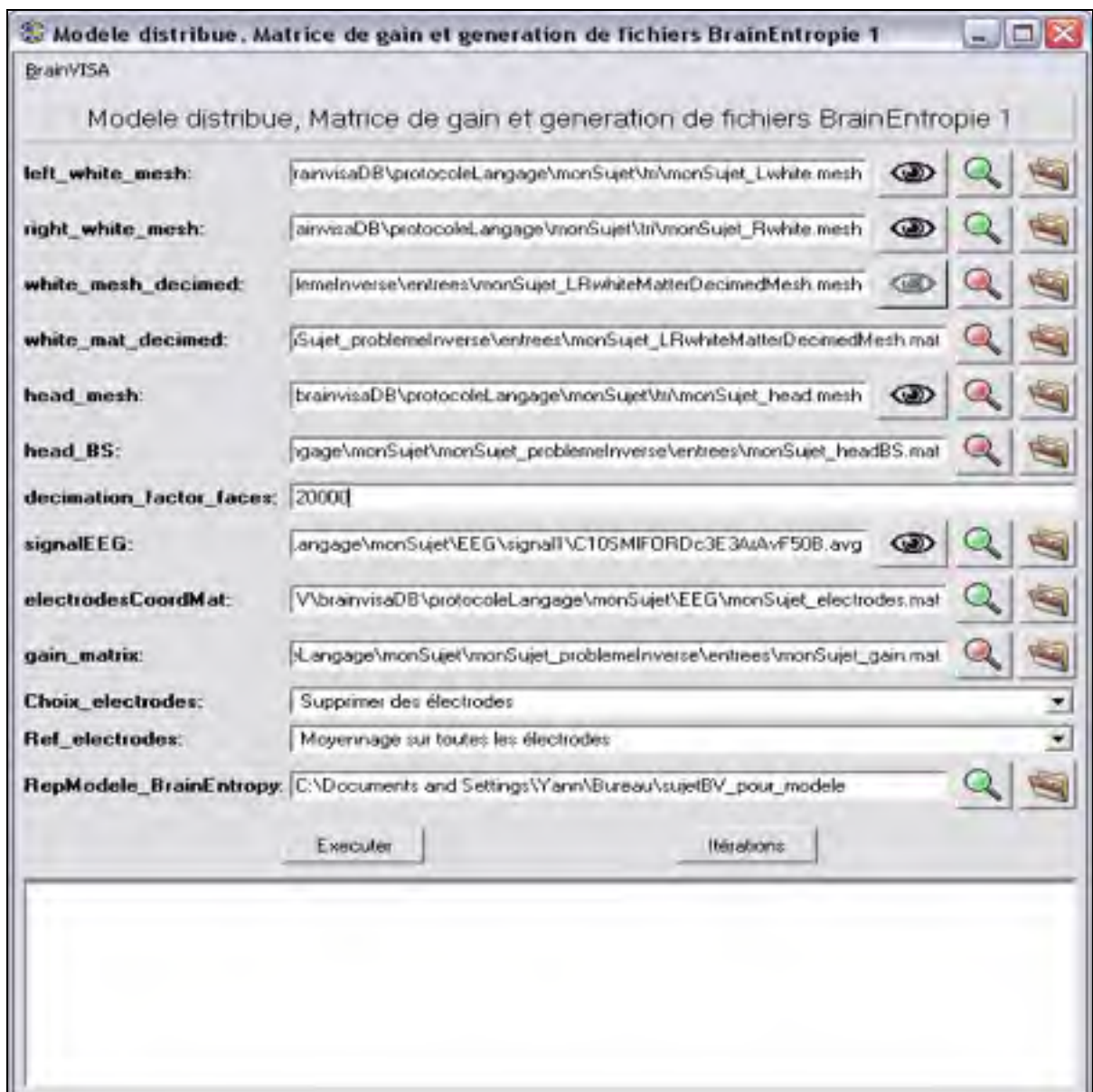
Figure 2.5 Étape 3 : Module de BrainVISA permettant d'obtenir le maillage des sources, les informations des capteurs et la matrice de Gain EEG.
