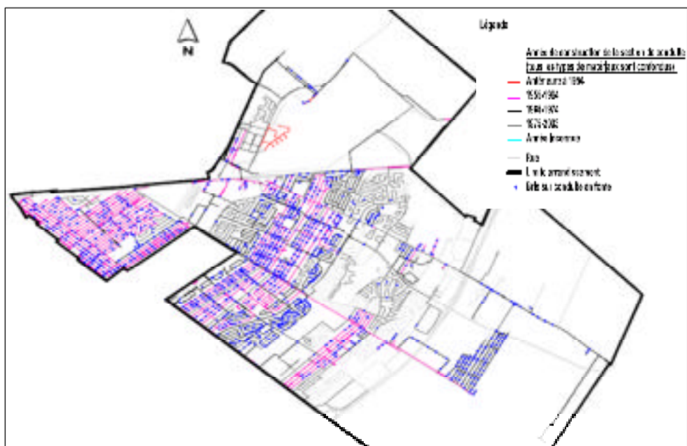
Figure EI - 3 Corrélation: âge de conduite – bris; Arrondissement AR-F.
