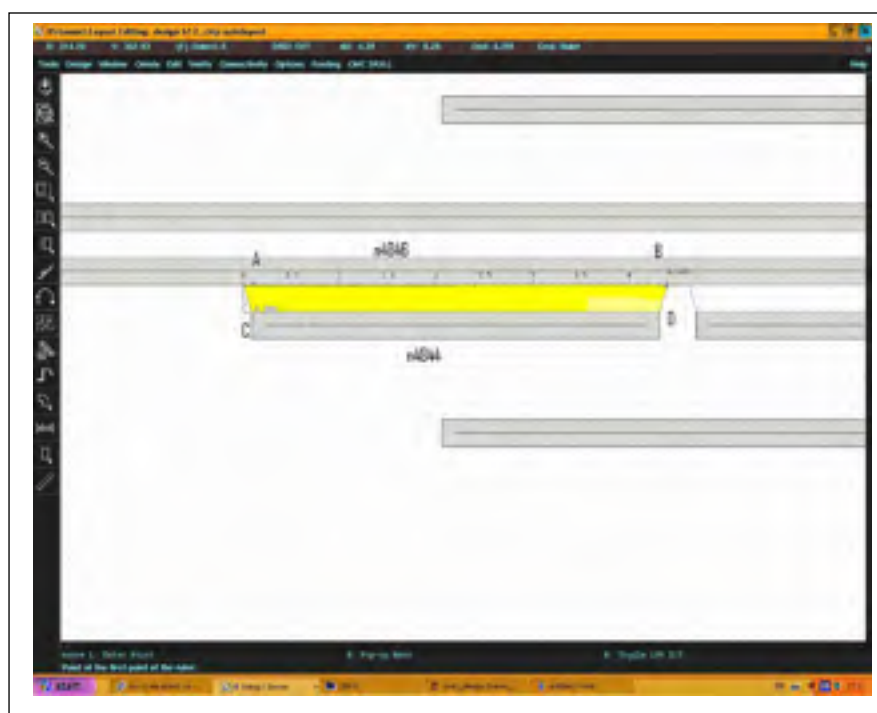
Figure 7-1 Approximation de la surface du polygone DRC (en jaune) par un rectangle.
