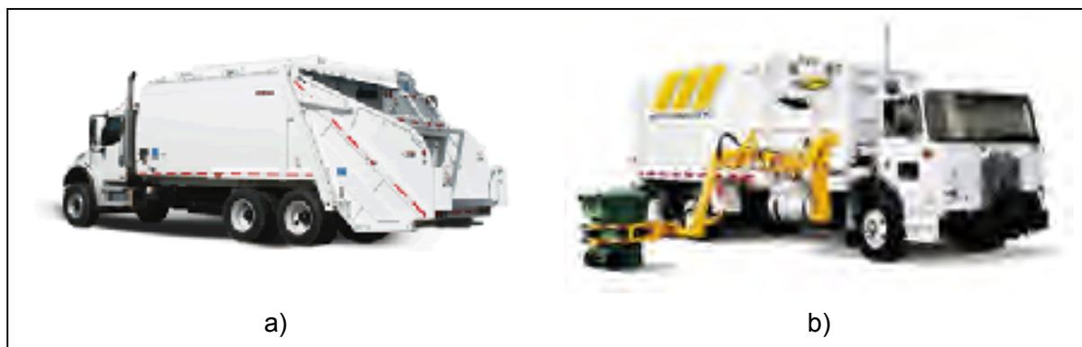
Figure 3.1 Camions à ordures; a) à chargement arrière, b) à chargement latéral automatisé
